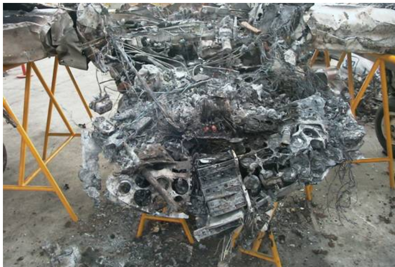
Рис. 2. Повреждение кабины летного экипажа и электронного авиационного оборудования в результате пожара
